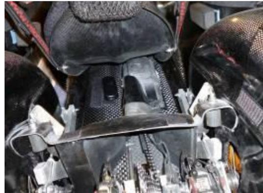
Une butée caoutchouc vient limiter le débattement.
