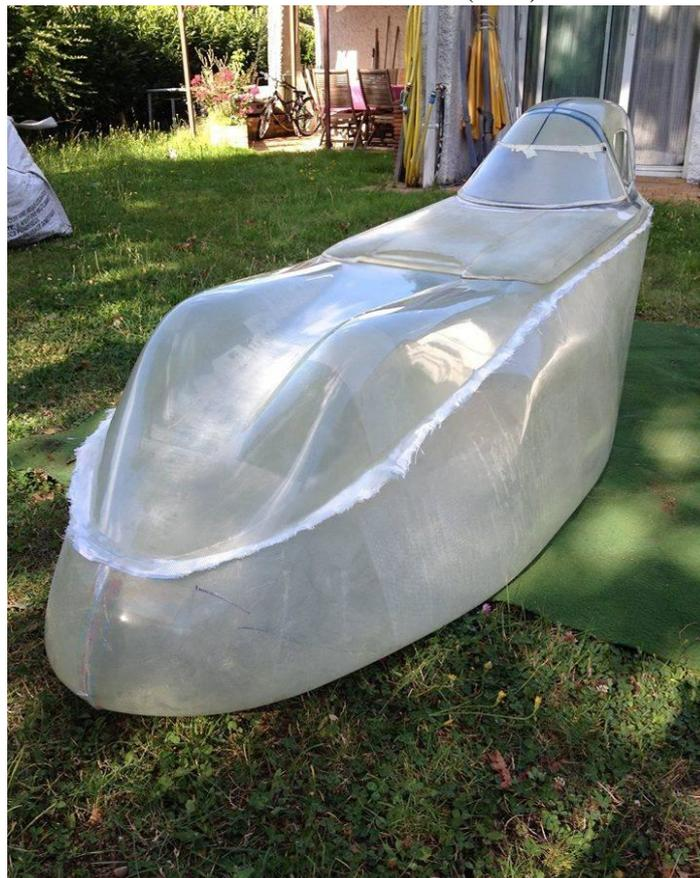
*Illustration 6: La coque sortie du moule, le Phantom prend forme*
