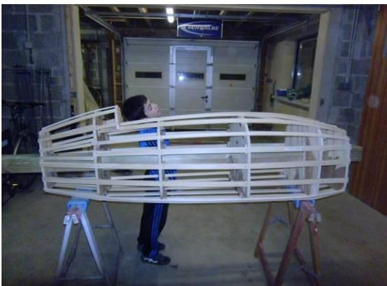
L'ossature en lattes est terminée, les jonctions sont ajustées par ponçage.
