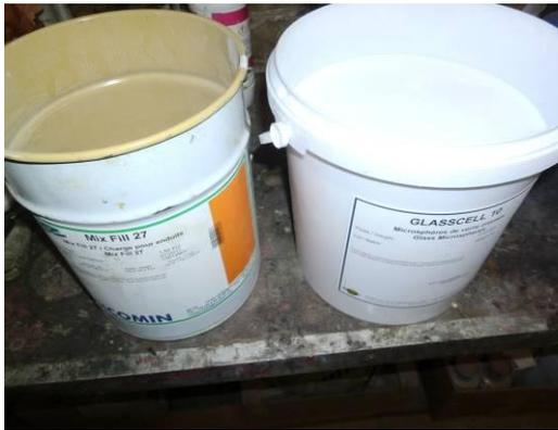
L'enduit est réalisé en mélangeant les 2 produits ci-contre avec de la résine jusqu'à obtenir la bonne consistance
