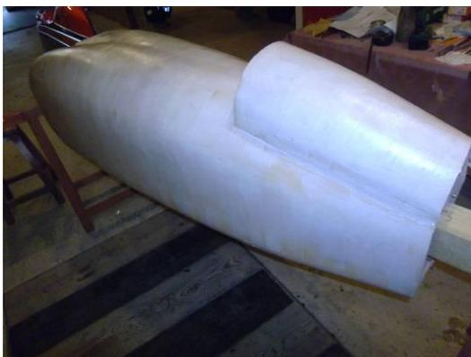
L'étape suivante consiste à mettre l'enduit allégé sur toute la surface pour combler les défauts.
