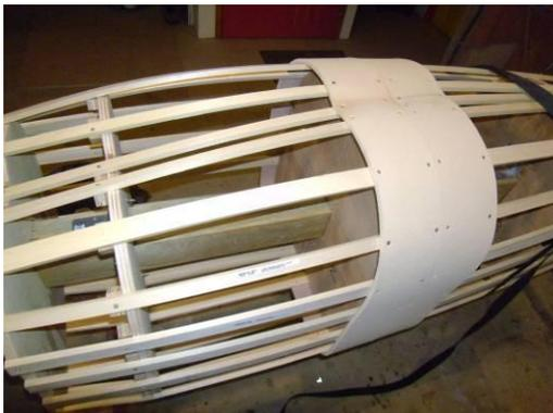
Le maintien des bandes de mousse est assuré par des vis de fixations vissées dans les lattes.
