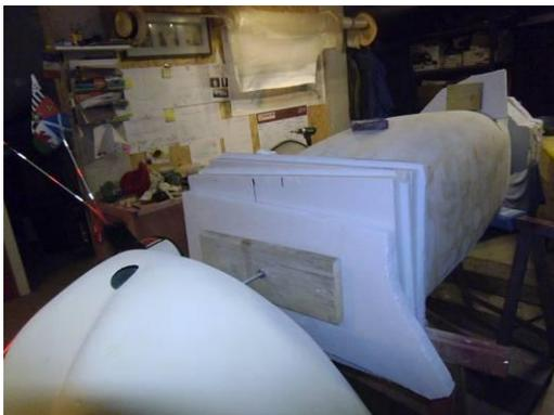
Une fois terminé le ponçage, les plaques de polystyrène extrudé sont fixées à chaque extrémité pour la réalisation des bouts
