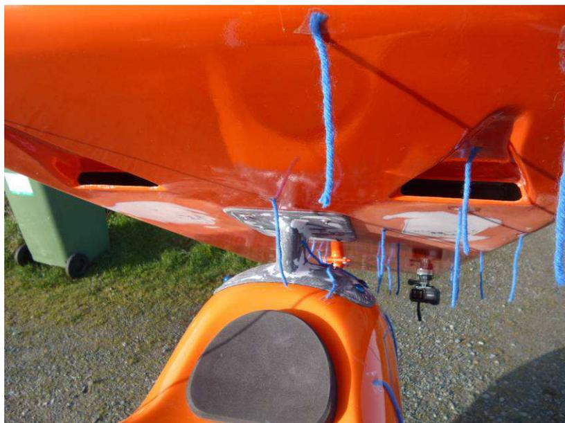
J'ai tout de suite senti la différence, avec ce type de fixation et le panneau la perte en vitesse maxi est estimée à 5%. Impression validée par un test avec une pointe à 100 km/h dans la fameuse descente des records.
