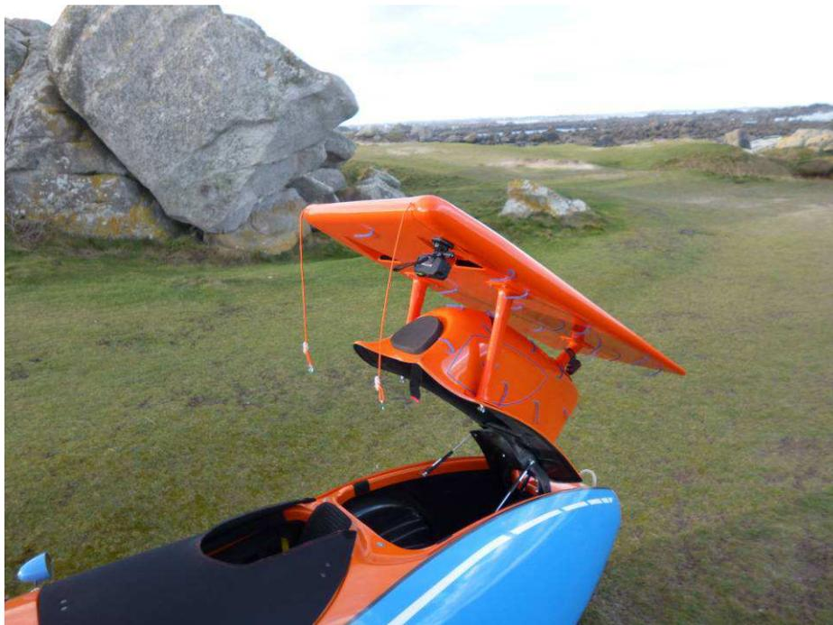
L'avantage du Quattro c'est aussi que l'on peut basculer le panneau à l'arrêt pour capter au mieux les rayons du soleil. Sur cette photo on voit les fils de laine utilisés pour visualiser les écoulements d'air.
