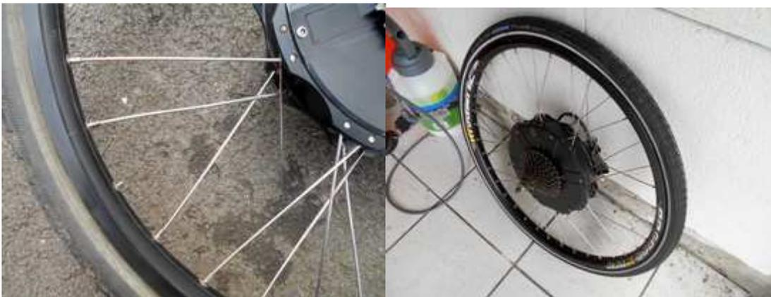
Echange du rayon (cassé dans l'écrou) et chipotage sous le fond jante pour poser le nouvel écrou.
