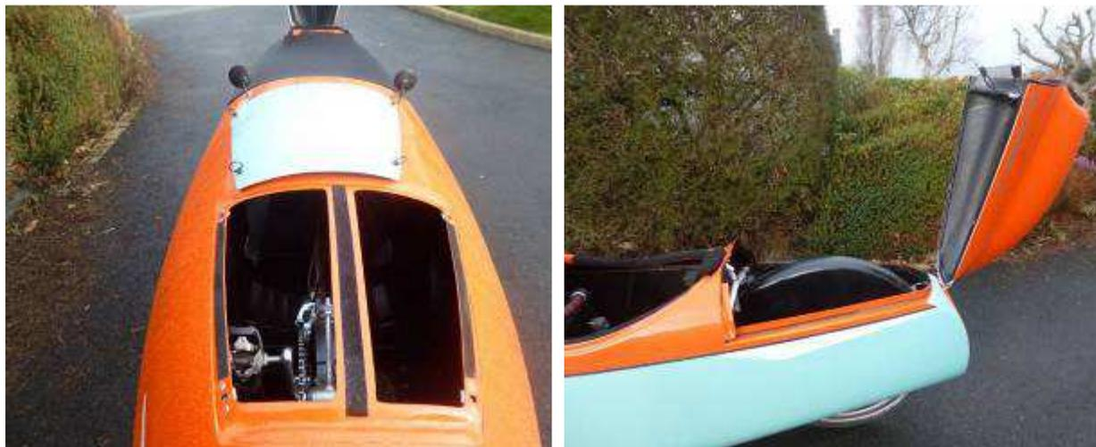
Les deux principales modifications apportées sur la coque pour le rendre plus pratique, une trappe à l'avant et le coqueron qui s'ouvre en entier. Bien sûr les zones découpées ont été renforcées par une cloison à l'arrière et par un raidisseur oméga longitudinal pour la trappe avant.
