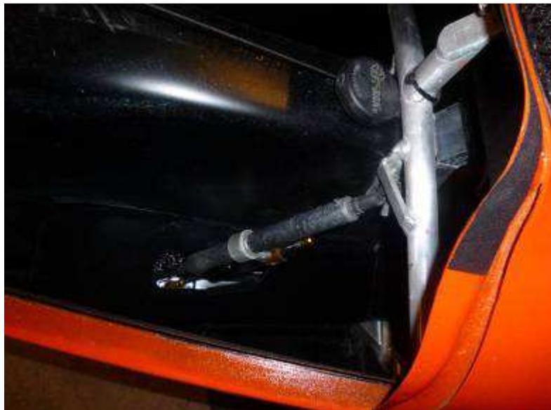
Un amortisseur à huile est ajouté en parallèle du système à ressort d'origine. Cet amortisseur a 14 positions pour le réglage de l'amortissement.
